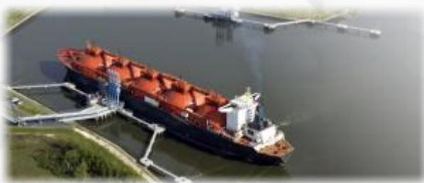
Il metano liquido, se fuoriesce dal serbatoio che lo contiene e finisce in acqua, molto più calda di lui, vaporizza diventando una nuvola densa, pesante e...esplosiva.
