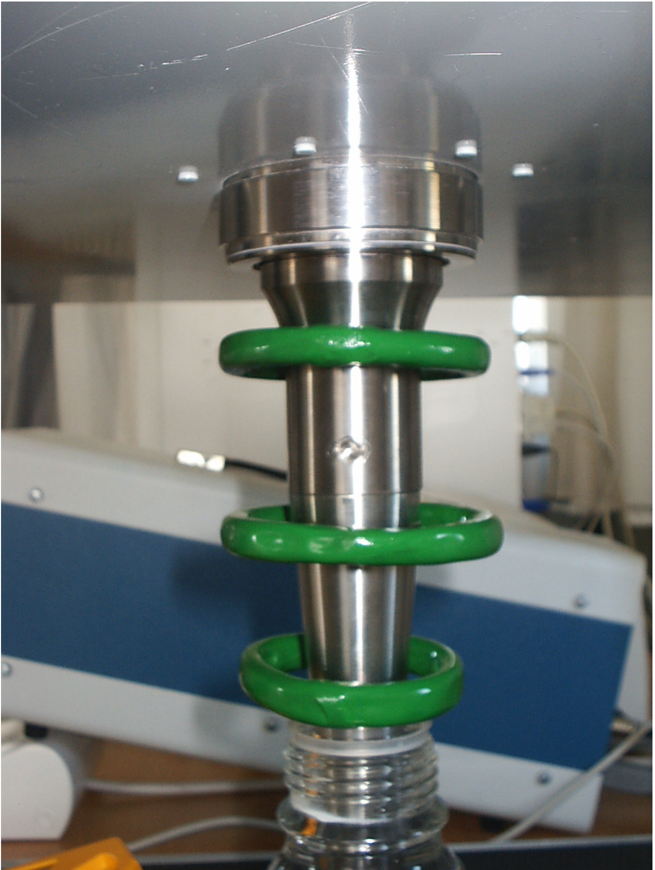
FIGURA 3 Il sonotrodo cavitatore parte principale del reattore ultrasonico
